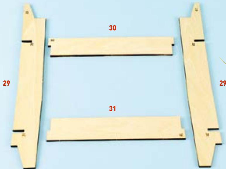
4 Вырежьте детали (29), (30) и (31). Они представляют собой бортовые стрингеры и поперечные распорки каркаса корпуса.
