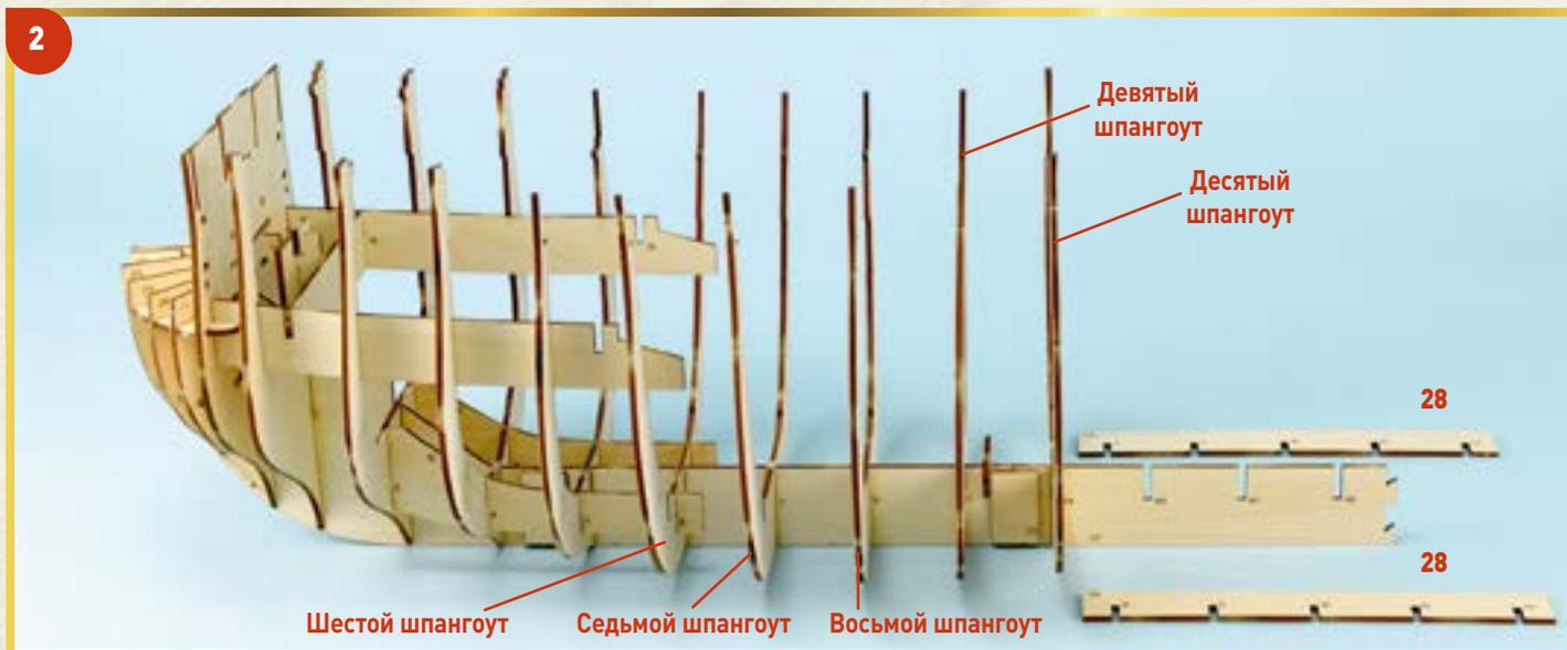
**2** Детали (28) представляют собой два стрингера, которые нужно установить параллельно килевой рамке на шпангоутах с шестого по десятый.
