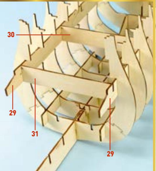
5 Установите детали (29) на шпангоутах (по одной с каждой стороны) так, как показано на фотографии. Затем установите поперечные распорки (30) и (31). Нанесите немного клея на места соединений этих четырех деталей, после чего приклейте концы стрингеров (29) к уже установленным деталям (13). Проследите, чтобы эти четыре новых элемента не приклеились к шпангоутам.
