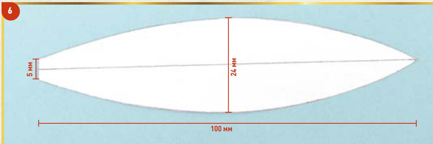
**6** Теперь вернемся к работе над шлюпкой. Скопируйте на лист бумаги приведенный на фотографии шаблон, следуя указанным размерам. Вырежьте его ножницами, а затем при помощи карандаша и линейки начертите на нем продольную осевую линию.
