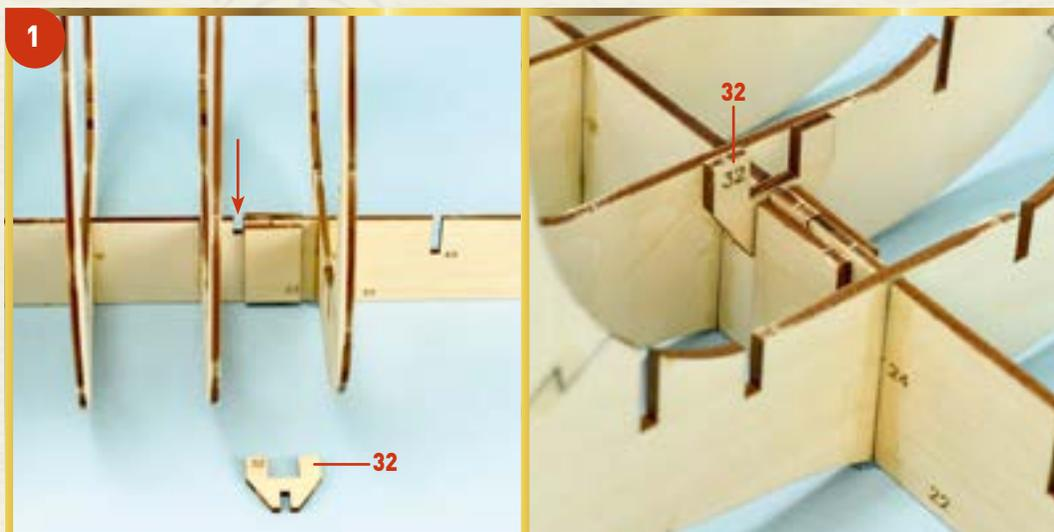
**1** Мы продолжаем работу над каркасом корпуса и начнем со степса (32), в который затем будет установлен шпор грот-мачты. Вырежьте деталь (32), прилагаемую к этому выпуску, и вклейте ее в паз килевой рамки, расположенный между двумя последними шпангоутами.
